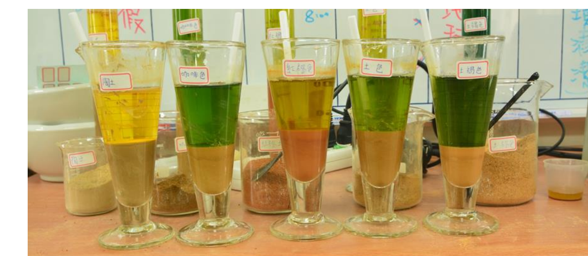
25g的陶土與花嶼土壤脫色比較實驗，水溶液顏色變的情形。
