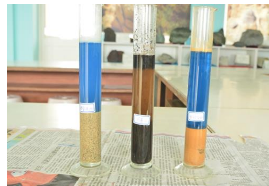
沙子、培養土及操場土壤都無法使水溶液產生脫色現象。
