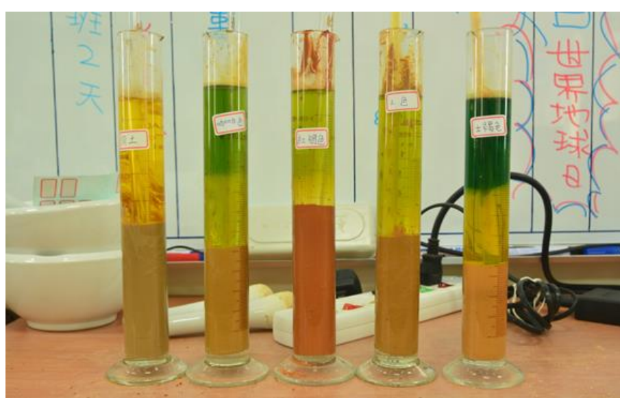
50g的陶土與花嶼土壤脫色比較實驗，水溶液顏色變的情形。
